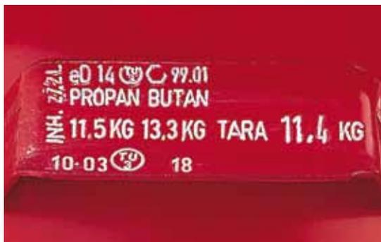
Flaschen-Prüfung: Die Intervalle betragen für Pfandflaschen 15 Jahre, für Nutzungsflaschen zehn Jahre. Der Prüftermin, das Füllgewicht sowie das Tara-Gewicht sind im Griff der Flasche eingepreßt.
